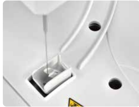
Nettoyage de la sonde par chute d'eau
