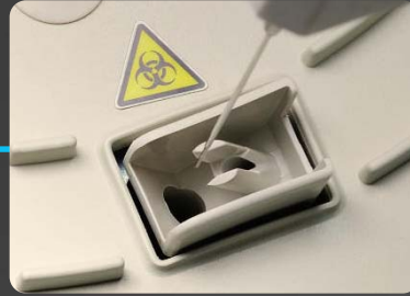
Nettoyage de la sonde cascade
